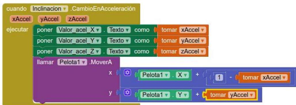
Cuando inclinemos el dispositivo hacia la derecha, en el eje X, la pelota caerá hacia la izquierda, y viceversa. Para solucionar este problema, y adaptar el funcionamiento al comportamiento natural de una pelota, fue que modificamos el bloque que indica el posicionamiento en la componente X de la coordenada. En lugar de sumarle el valor de xAccel le sumaremos el valor de restar xAccel a 1.
